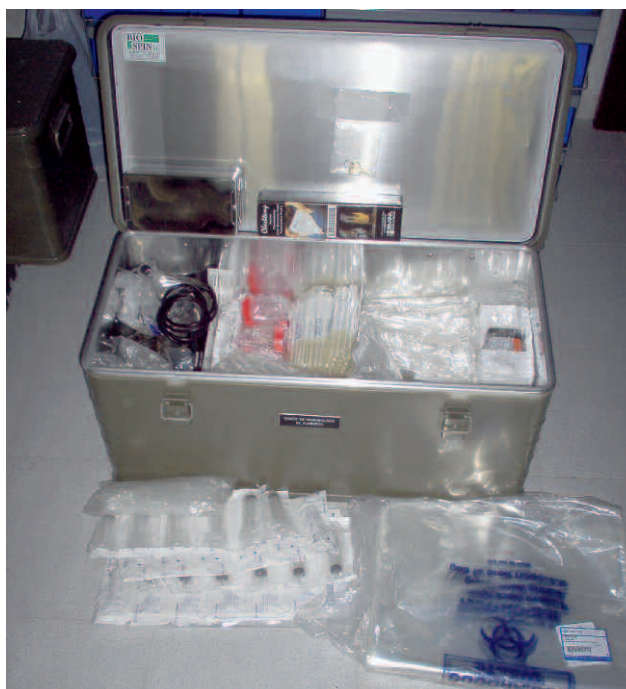
Figure 3 : Lot de microbiologie alimentaire. Cet équipement permet la recherche et l'identification de germes tels que les salmonelles, les staphylocoques, les entérobactéries dont Escherichia coli , voire de moisissures et levures (voir texte). Il est utilisé pour vérifier la sécurité des surfaces de contact et des aliments.
