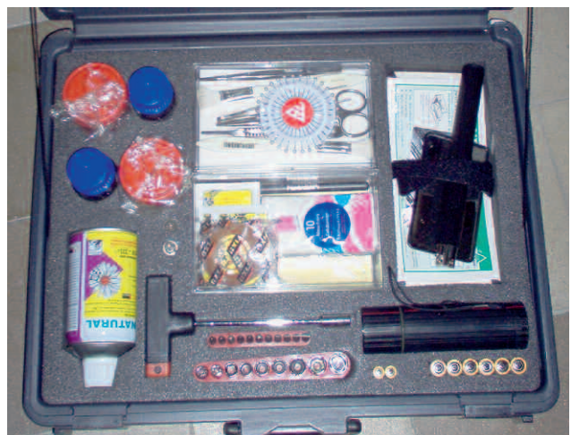
Figure 4: Trousse de contrôle de la présence de nuisibles. Elle contient tout le matériel nécessaire à la recherche et à l'inspection des nuisibles (lampes torches, outils de démontage, loupe, bombe de produit insectifuge, flacons de prélèvement, etc.).
