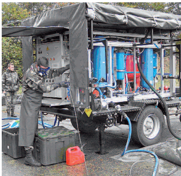
Figure 1 : Station légère de traitement de l'eau potable par osmose inverse de l'armée de terre.
